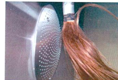
Bild 4 Ansaugsieb 2 während der Prüfung
